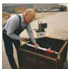
Vyrovnávanie kontajnerovej deby pomocou hydraulického valca YS-10/100, predĺžovacieho nástavca AYS-106, adaptéra AYS-103 a elektrického čerpadla PY-04/2/5/2 M.
